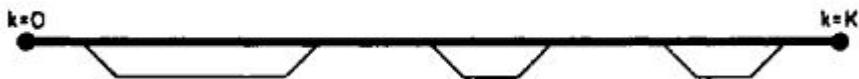
Figura 16: Tipico caso di cammino corretto x (linea spessa) e cammino stimato \hat{x} (linea sottile) nel trellis, mostra gli eventi di errore nell'albero.
