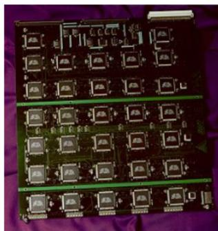
Nel 1996 il DES è violato, nel 1997 (progetto DESCHALL) è violato in pubblico, nel 1998 Il DES cracker dell'EFF (Deep Crack—250K\$) viola una chiave DES in 56 ore.
