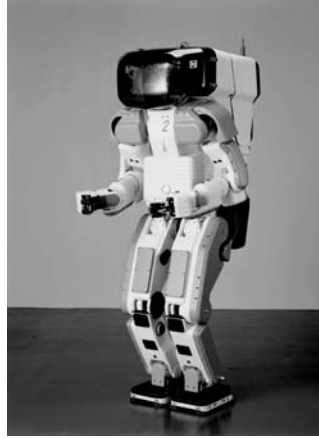
Figure 4.48 – Le robot humanoïde P2 (1996) (autorisation de Honda Motor Co., Ltd).
